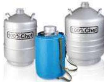
I Dewars possono essere aperti o muniti di tappo con tubo di sfiato o altro dispositivo che permetta lo scarico del vapore ed eviti il formarsi di pressioni troppo elevate. E’ buona norma ispezionare frequentemente i dispositivi di scarico dei contenitori per accertarsi che non siano bloccati dal ghiaccio che può formarsi per effetto della condensazione dell’umidità atmosferica.
